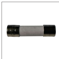
531414 Fusible céramique G 5x20 mm T6,3A H 250V
